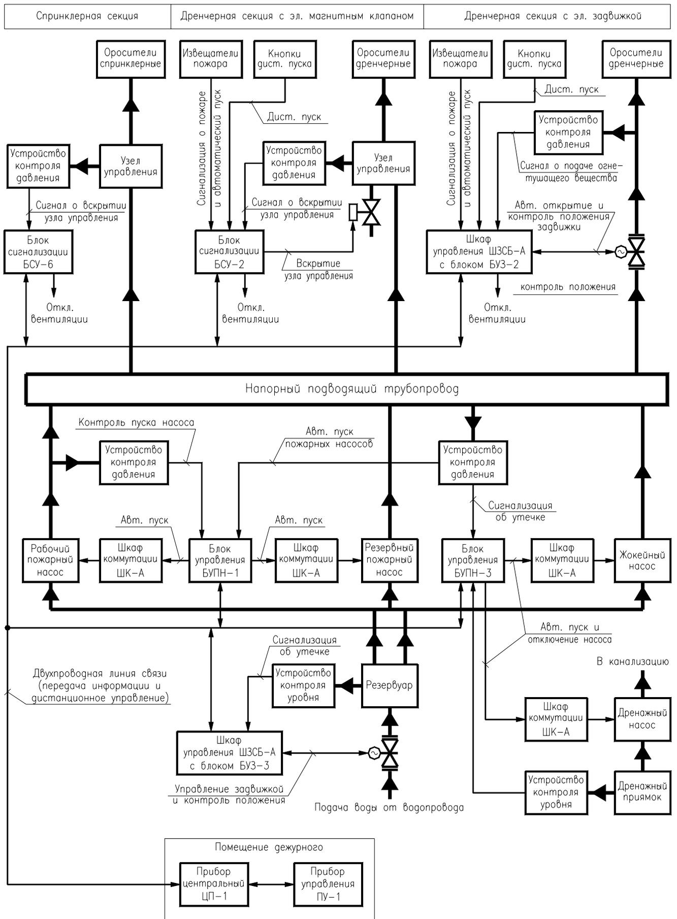
Рисунок 2.2 - Структурная схема управления установкой водяного пожаротушения
