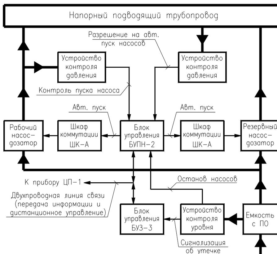
Рисунок 2.3 - Структурная схема управления насосами - дозаторами
