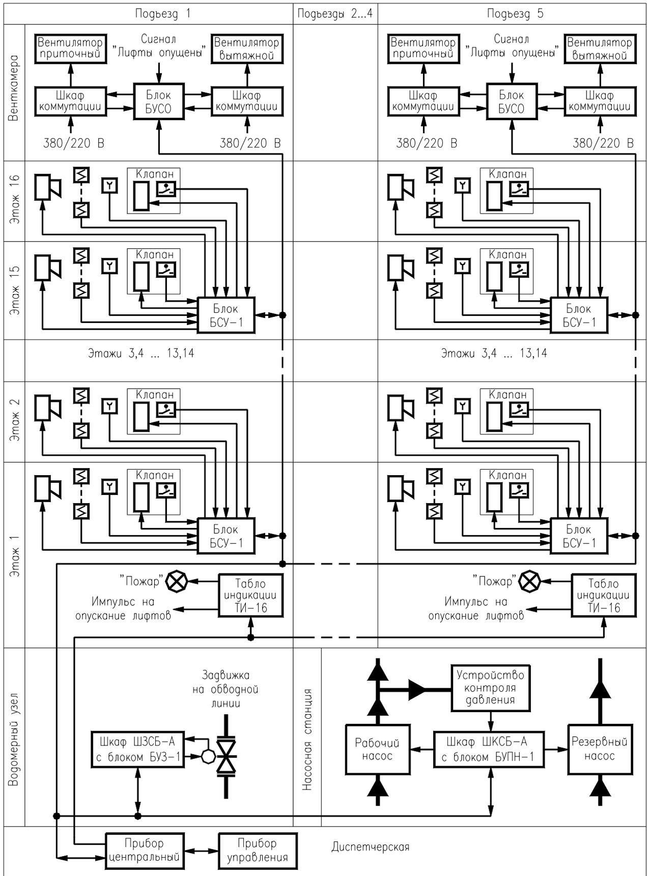
Рисунок 2.1 - Структурная схема автоматизации системы противодымной защиты
