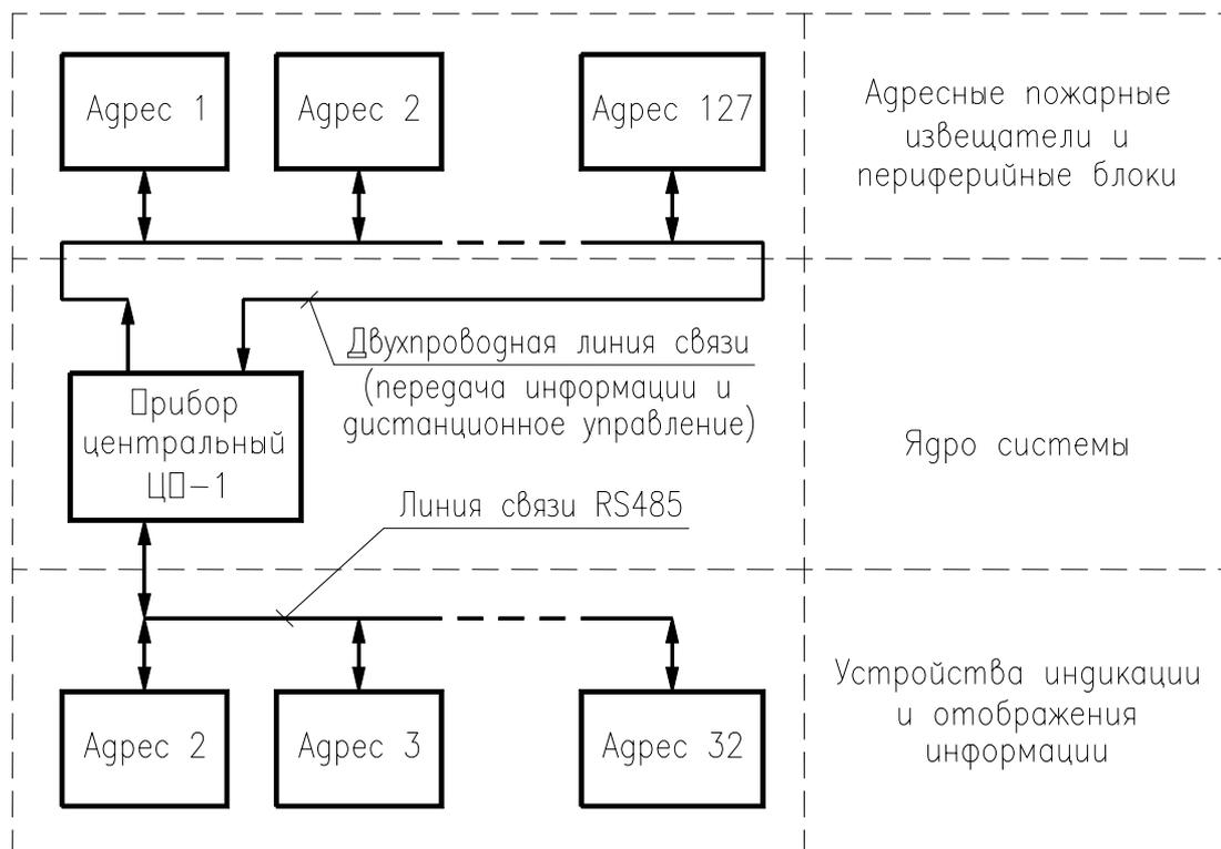
Рисунок 1.1 - Структурная схема адресной системы
