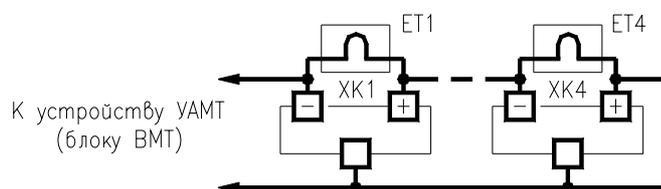
Рисунок 2.5.2 - Схема подключения модулей к коробкам КПП
